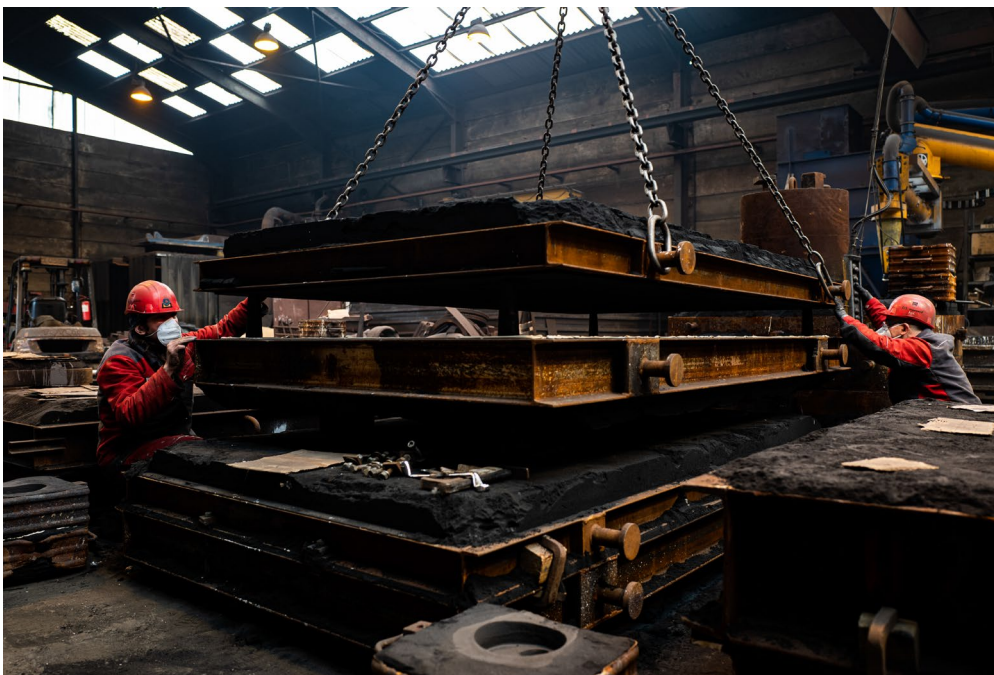
Coulage des éléments de la clôture © Ville de Luxembourg – Service Communication et relations publiques, Tom Jungbluth
