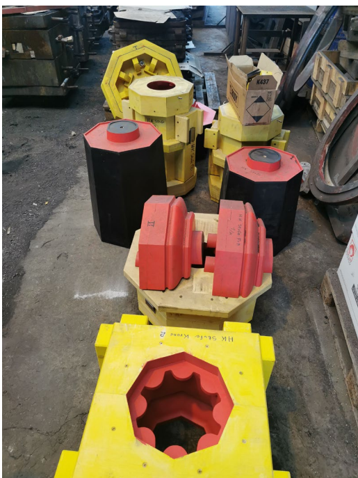
Réalisation des nouveaux moules
